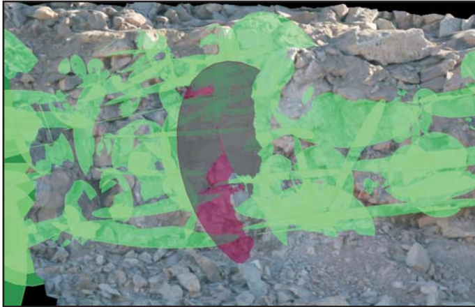
Mapeo de fábrica en taludes utilizando el software 3DM de Adamtech
